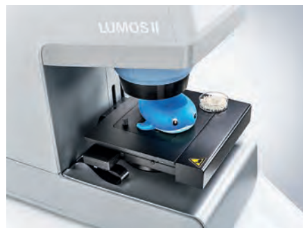
Obr. 6 – Ukázka velkého vzorkovacího prostoru mikroskopu – analýza velryby pomocí FTIR mikroskopu LUMOS II
