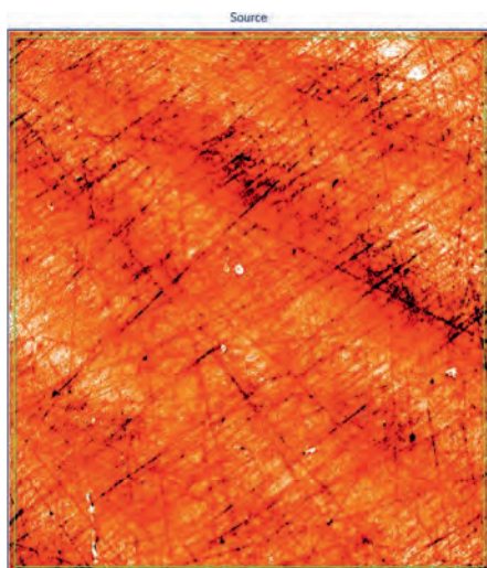
Obr. 4: Výběr plochy pro vyhodnocení na základě plošné drsnosti S_a a S_q vzorku 1.
