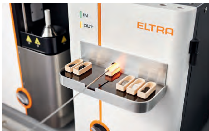
Obr. 4: Analýza organického vzorku v odporové peci
