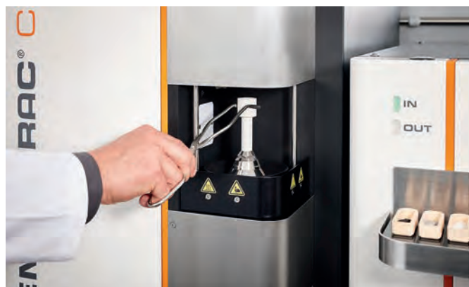
Obr. 3: Analýza anorganického vzorku v indukční peci
