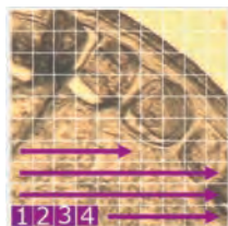
Obr. 5 – Schematická ukázka rozdílu mezi FTIR mapováním a FTIR imagingem:
