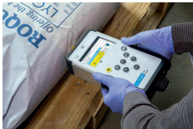
Obr. 1: Ověření totožnosti surovin přes vícevrstvé papírové pytle pomocí Agilent Vaya
