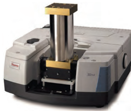
Obr. 3: FTIR Nicolet iS50 s dlouhocestnou 10 m kovovou celou
