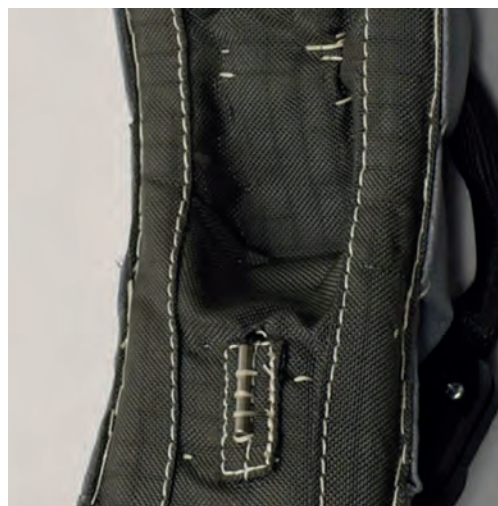
Obr. 4: Přichycení čidla na ohřivači
