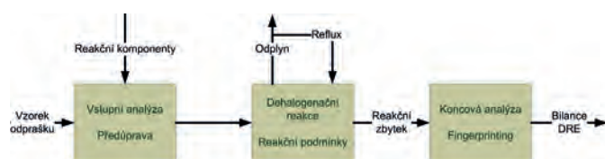
Obr. 1 – Schéma procesu detoxikace metodou CDC pro odprašky z metalurgie
