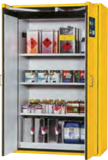
Skříň pro bezpečné skladování S-CLASSIC-90 Model S90.196.120 / S90.196.120.WDAS (vč. zádržného systému otevřených dveří) ve výstražném žlutém provedení (RAL 1004), 3 police a spodní sběrná olejová vana (ocelový plech laminovaný plastem), volitelná perforovaná vložka Objednací číslo 30115-002-30130 (skříň bez zádržného systému otevřených dveří) Objednací číslo 30116-002-30130 (skříň včetně zádržného systému otevřených dveří)
